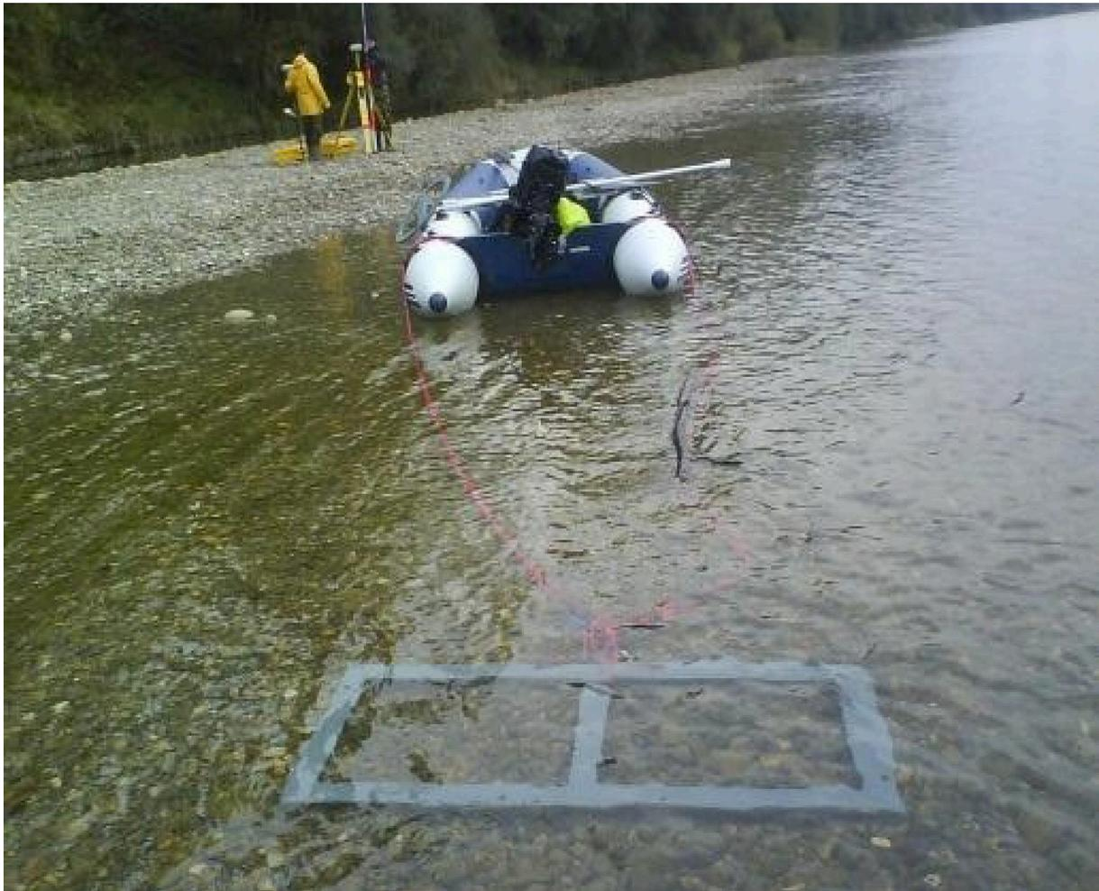
Figure 5. Recherche embarquée de traceurs avec une antenne de 0,4 x 1,1 m (source : D. Béal, Vieux Rhin)
